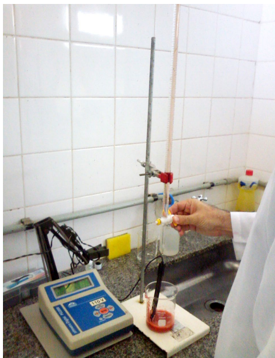
Figura 5: Procedimento de titulação da polpa de morango com solução de ácido cítrico.
