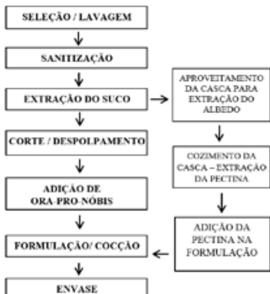
Figura 2 - Fluxograma do processamento de geleia artesanal de maracujá enriquecida com ora-pro-nóbis.
