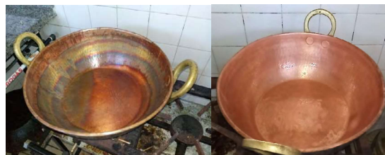
Figura 10: Tacho antes e depois da retirada do zinabre.
