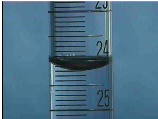
Figura 4: Exemplo de medida correta de volume com uso da bureta.
